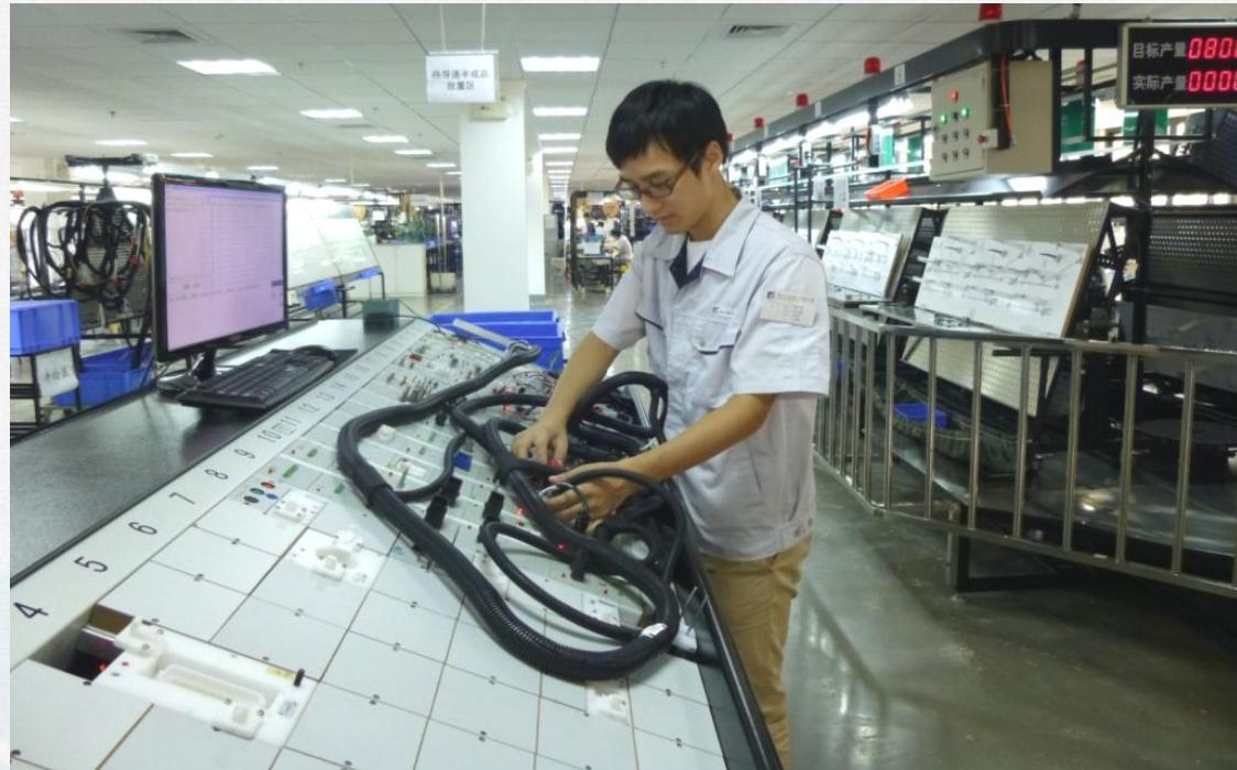
**通电检测: 生产成品线束100%通电检测**
